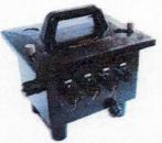
Vollgummi - Verteilerkasten zum Anschluss an Kraftstrom (400V), mit drei Leitungsschutzschaltern (16 Ampere) und einem FI - Schalter.
